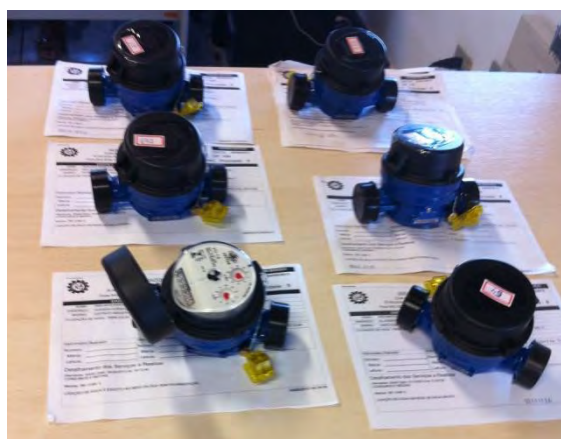
Figura 54 - Fotos (Hidrômetros para instalação) FONTE: UNILIVRE, 2.013.
